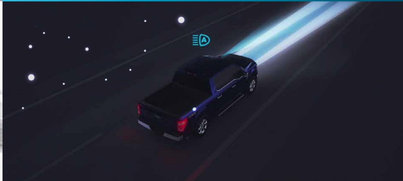
Las luces altas se activan automáticamente para brindar máxima visibilidad y se desactivan automáticamente cuando viene otro vehículo de frente, evitando el encandilamiento de los conductores.
